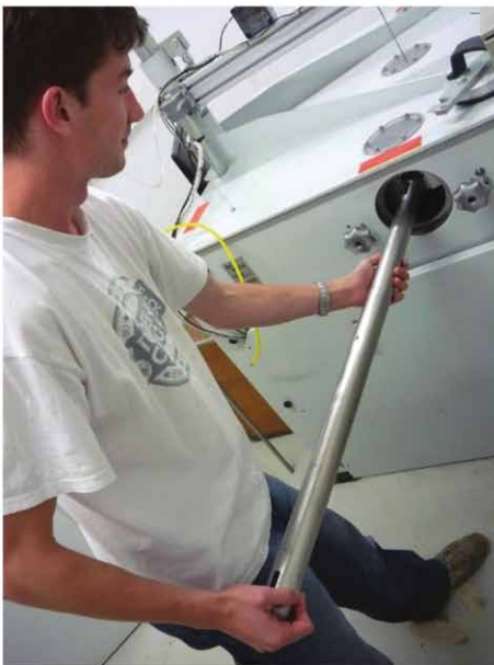
FIGURE 3. LE DERNIER-NÉ DES CAVITRONS DESSINÉ POUR MESURER DES ESPÈCES À VAISSEAUX TRÈS LONGS: LE CAVI1000 – © R. SÉGURA
