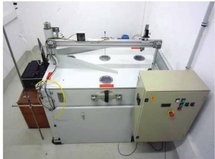
FIGURE 3. LE DERNIER-NÉ DES CAVITRONS DESSINÉ POUR MESURER DES ESPÈCES À VAISSEAUX TRÈS LONGS: LE CAVI1000 – © R. SÉGURA
