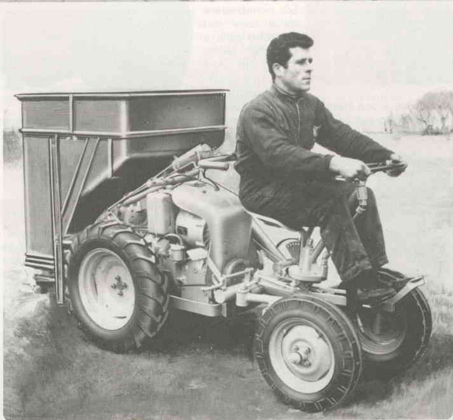
Caratteristica principale del motocoltivatore Pasquali "900 Fr", una delle prime macchine prodotte da Pasquali, la possibilità di accessoriarlo con un asse sterzante con posto guida reversibile che trasformava la macchina in un vero e proprio trattorino. Il mezzo era mosso da un diesel Ruggerini da 18 cavalli di potenza
